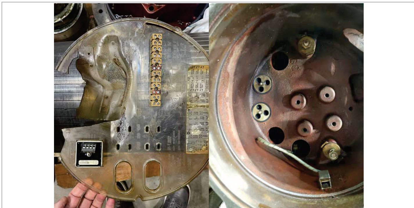
Фото 3: Отсутствие силового клеммника, оплавление пластины
